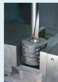
Просверливание пакетов деталей.
