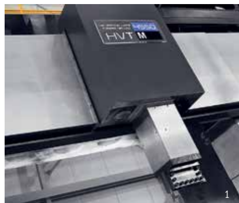
1 Подвижный инструментальный суппорт (редуктор/моторшпиндель) 2 Высокомоментная токарная планшайба (до 280 000 Нм) 3 Устройство автоматической смены инструмента
