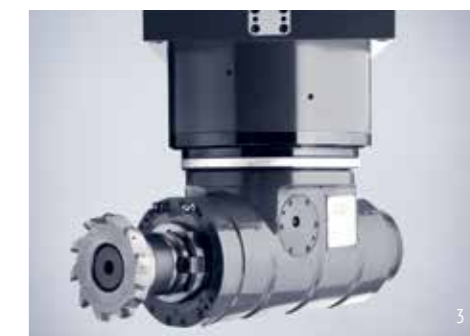
1 Устройство автоматической смены инструмента. 2 Станина с направляющими скольжения 3 Угловая фрезерная головка (72x5° дискретность)
