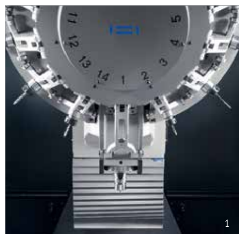
1 Устройство автоматической смены инструмента 2 Наклонно-поворотный накладной стол 3 ШВП
