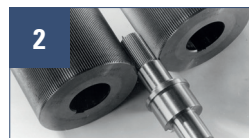
1 Шлиценакатный станок 2, 3 Примеры шлицов
