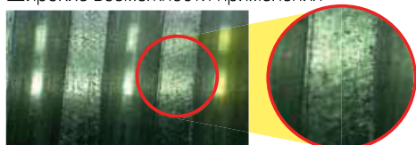
DST22 ( v_c = 100\text{ м/мин} ) Отличная обработанная поверхность
